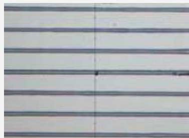
線幅3 \mu\text{m} 的線條繪製 (Resist)
